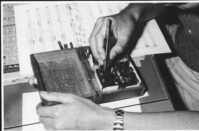
ツゲでできた木ハンのセット。木の乾燥度、弾力性などでツゲが一番。数種類のサイズがある。
